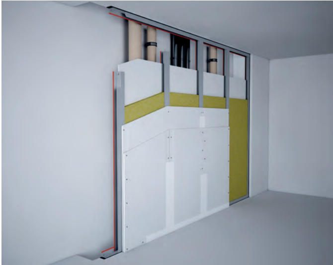
SW35 SW P01 – Schachtwand mit eingestellter Gipsplatte
